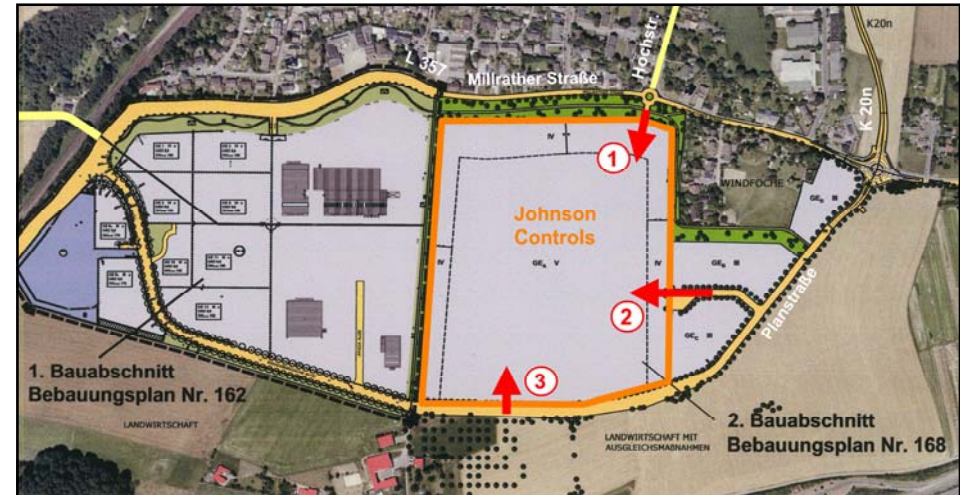
Bild 4-1: Erschließungsmöglichkeiten Johnson Controls
