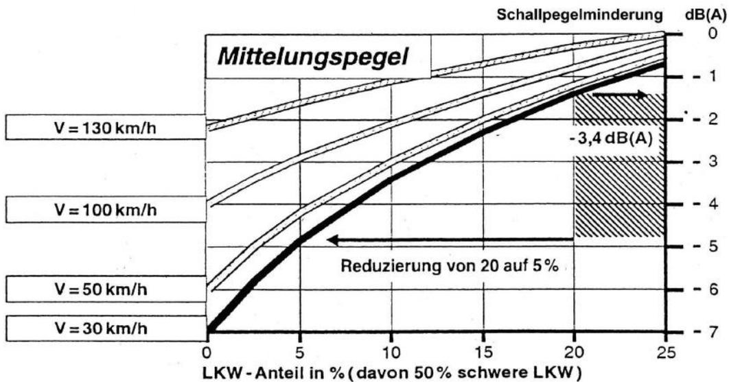
Abb. 4.2 Schallpegelminderung in Abhängigkeit von der Veränderung der Lkw-Anteile und der Geschwindigkeit<sup>17</sup>
