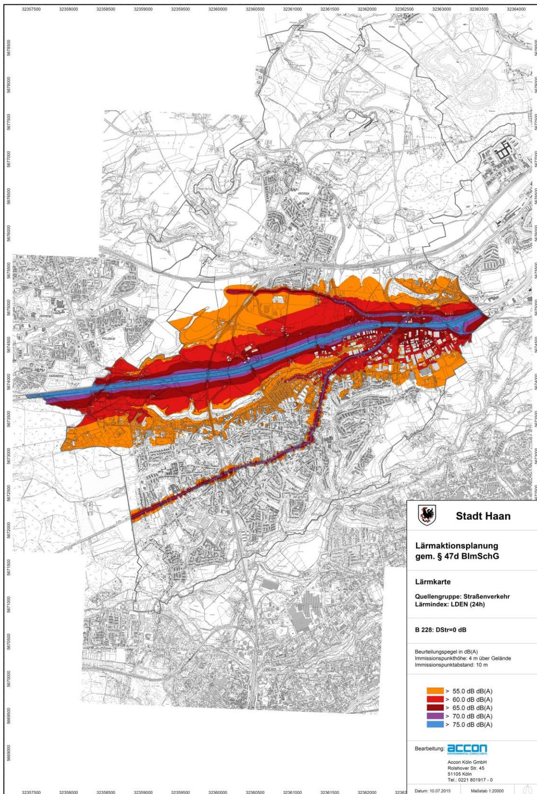
Abb. 3.3 Schalltechnische Untersuchung zur Stufe II der EU- Umgebungslärmrichtlinie für die Stadt Haan  $L_{DEN}$  (Berechnung B 228 Standardasphalt).<sup>10</sup> (Quelle: eigene Berechnungen auf Kartengrundlage ©Kreis Mettmann).
