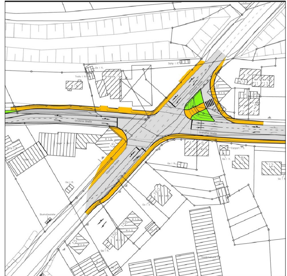
Bild 4-10: Knotenpunkt Polnische Mütze mit optimierte Lichtsignalanlage März 2010: Variante 2-1
