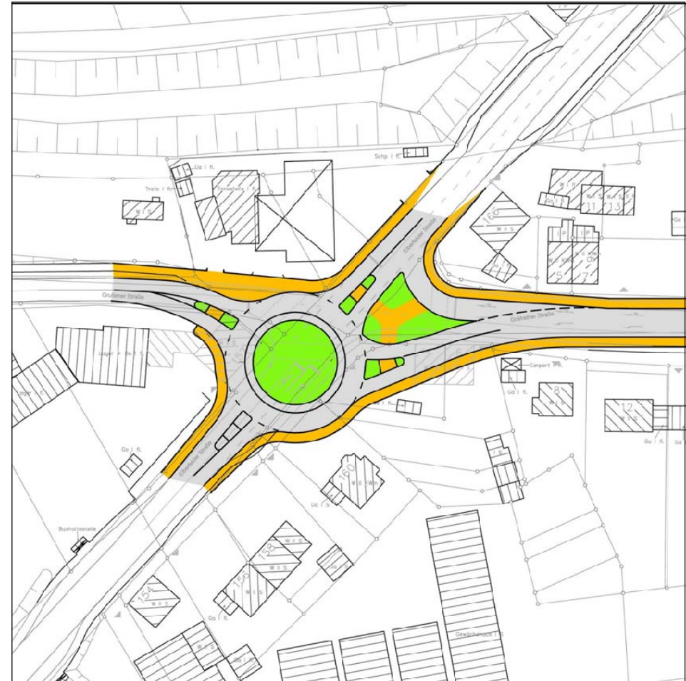
Bild 4-9: Knotenpunkt Polnische Mütze als Kreisverkehr Untersuchung März 2010: Variante 1-3
