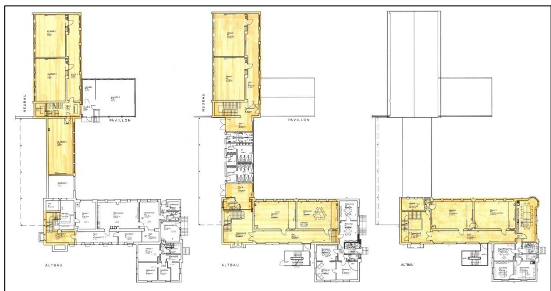
Bild 6-1: Farbige Kennzeichnung der Räume mit PCB-Primärquellen im UG, EG und OG (von links nach rechts) der GGS Gruitzen
