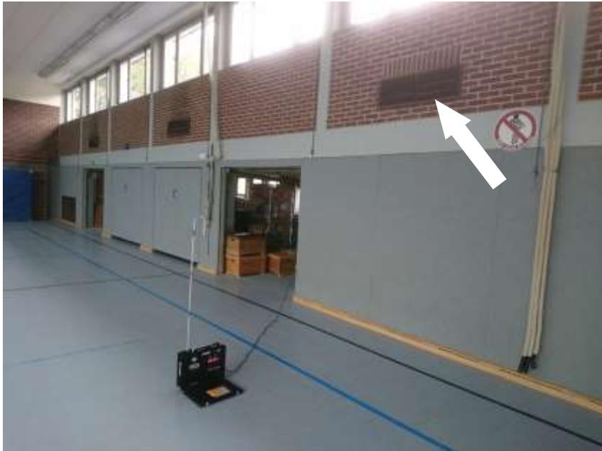
Turnhalle, Messung der Asbestfaserbelastung, Luftauslassgitter in der Wandebene
