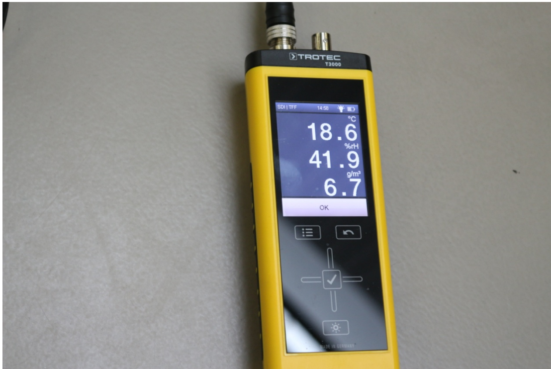
Bild 2: Klima an der Bodenoberfläche (18,6°C, ca. 42% rel. Feuchte)
