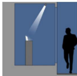
Licht gerichtet auf auszustellende Objekte und Waren
