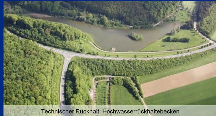
Technischer Rückhalt: Hochwasserrückhaltebecken
