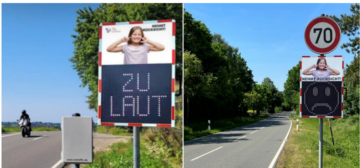
Abbildung 34: Dialog-Displays: Beispiele für Lärmdisplay – Symbolbild (Quelle Fotos: „via NRS Lärmdisplay“ – Website der via traffic controlling gmbh, Campusallee 1, 51379 Leverkusen)
