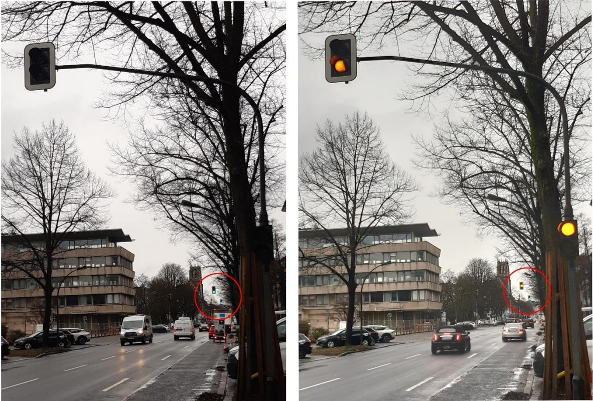
Abbildung 33: Vorsignalisierung zur Lichtsignalanlage (LSA) – Symbolbild
