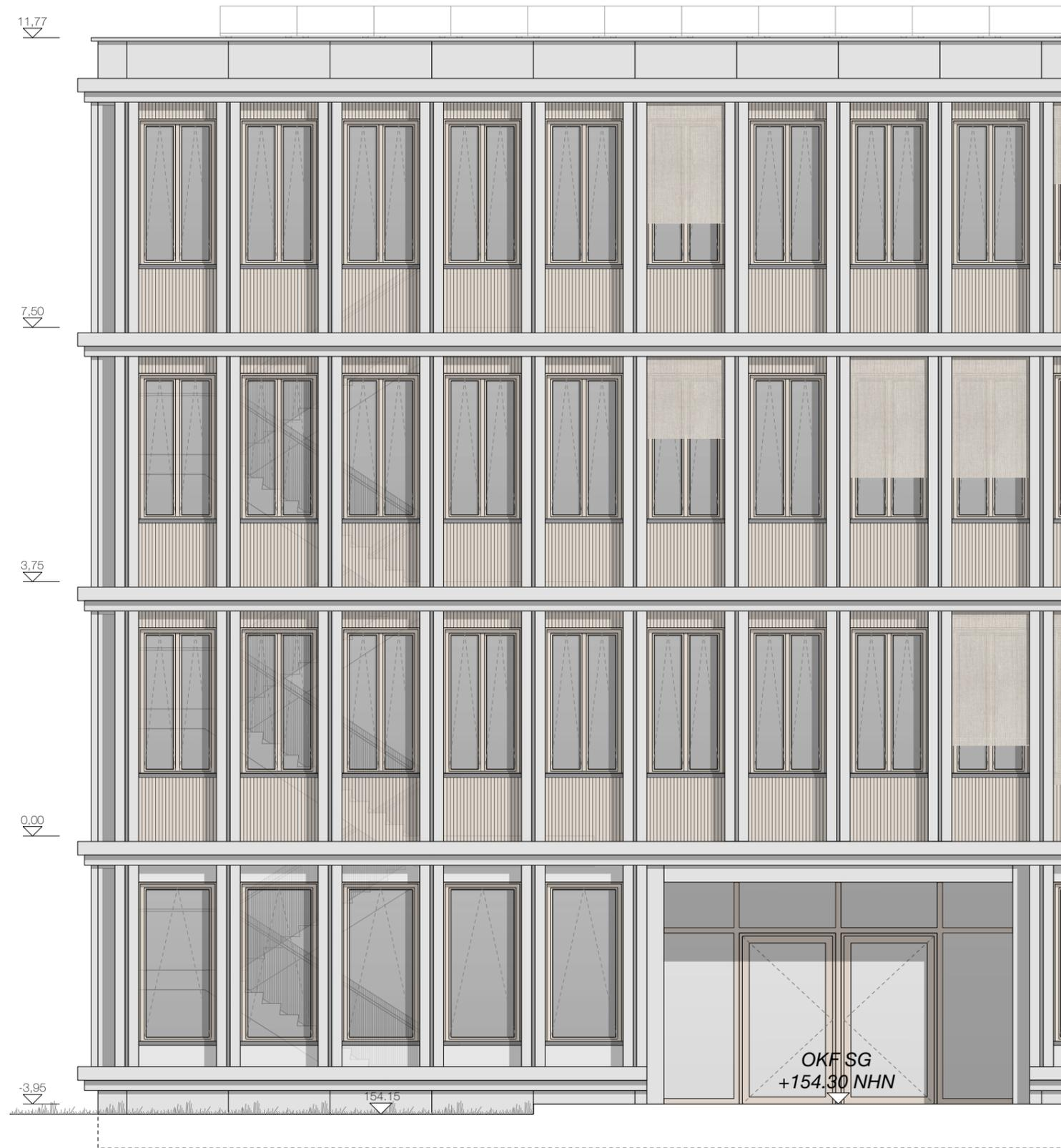
elementierte Fassade in Fertigteil-Modulbauweise umspannt die beiden Baukörper
